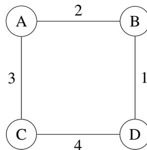
Der Algorithmus von Kruskal wählt die Kanten in der Reihenfolge  $\{B, D\}, \{A, B\}, \{A, C\}$ , der Algorithmus von Jarník-Prim wählt sie dahingegen in der Reihenfolge  $\{A, B\}, \{B, D\}, \{A, C\}$ .
